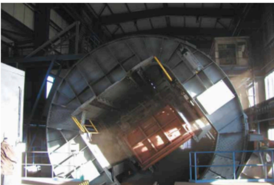
The bucket is turned by 180° with the help of an igus® e.chainsystem® Der Wagon wird mit Hilfe einer igus® e.kette® um 180° gedreht
